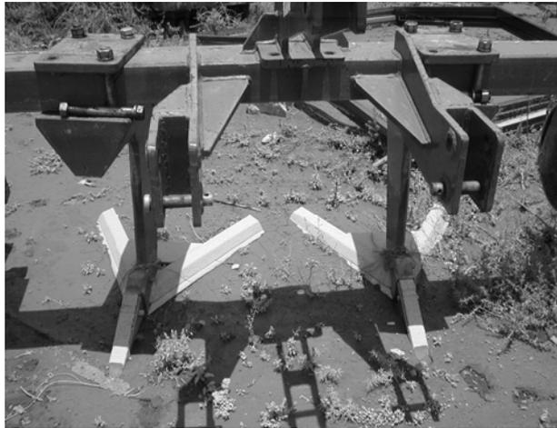
Figura 1. Fotografía del multiarado formado por un cincel con una punta de arado y aletas cortadoras.
