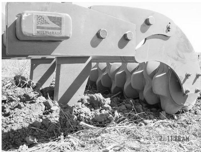
Figura 9. Rodillo Aqueel adaptado a un arado implemento de subsuelos para la siembra posterior de granos pequeños.
