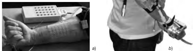
FIGURA 26. Compensació del tremolor patològic: a) amb EEF i b) amb exosquelet.
