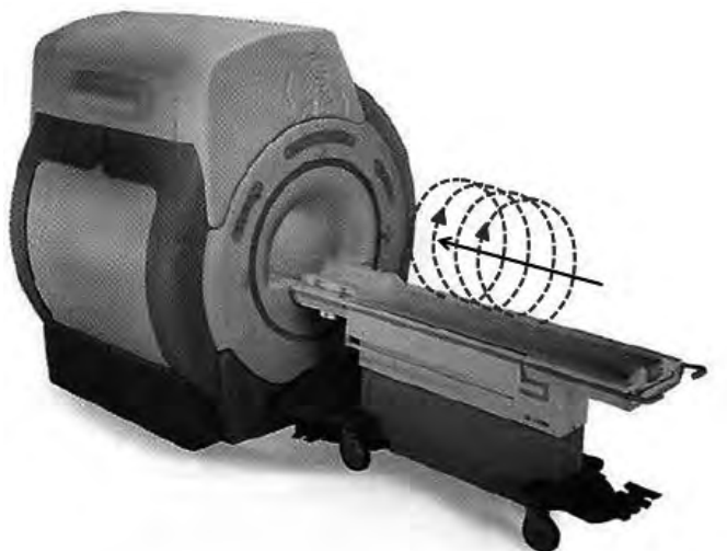
FIGURA 11. Exploració helicoidal per rotació del camp magnètic i avanç simultani de la llitera del pacient.
